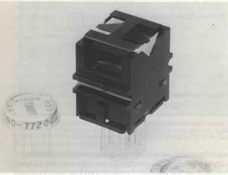
*Il Visitronic della Honeywell contiene un circuito che controlla automaticamente il fuoco di un apparecchio fotografico paragonando due immagini "viste" elettronicamente. La fotografia mostra il circuito e il contenitore in cui è posto.*
