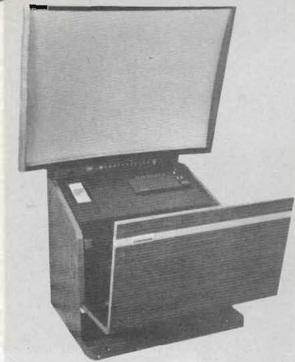
È con schermo integrato (da 50 pollici) e proiezione anteriore, il videoproiettore della Pioneer che dispone di 12 canali presintonizzabili e di audio stereo con diffusori a due vie.
