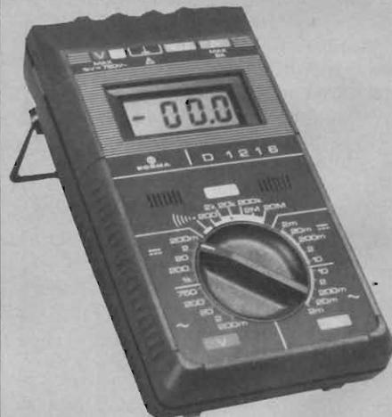
Multimetro digitale con display a cristalli liquidi con 27 gamme di misura.
