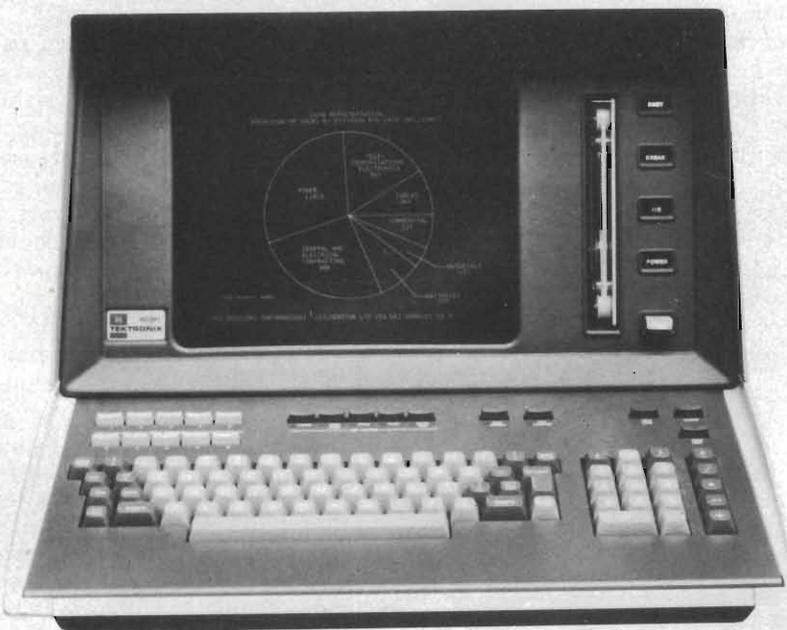
Il calcolatore da tavolo Tektronix 4051 è stato migliorato nelle sue caratteristiche, senza venire aumentato di prezzo. Il 4051 è un calcolatore autosufficiente, programmabile in BASIC, con capacità grafiche. L'unità comprende ora 16 kbyte di memoria e le funzioni per il caricamento binario e matriciale, che erano in precedenza disponibili come opzioni.
