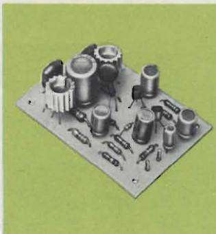
Circuito miniaturizzato di uso universale per applicazioni su apparecchi radio portatili, fonovaligie, microregistratori ecc. Ottimo per funzionare in combinazione con il sintonizzatore UK 521. Ottima fedeltà e sensibilità.
