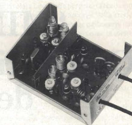
Fig. 3 - Uno dei prototipi del convertitore, ultimato e pronto all'impiego. Si nota lo schermo che separa il gruppo oscillatore (retrostante) dal circuito d'ingresso (sul fronte).
